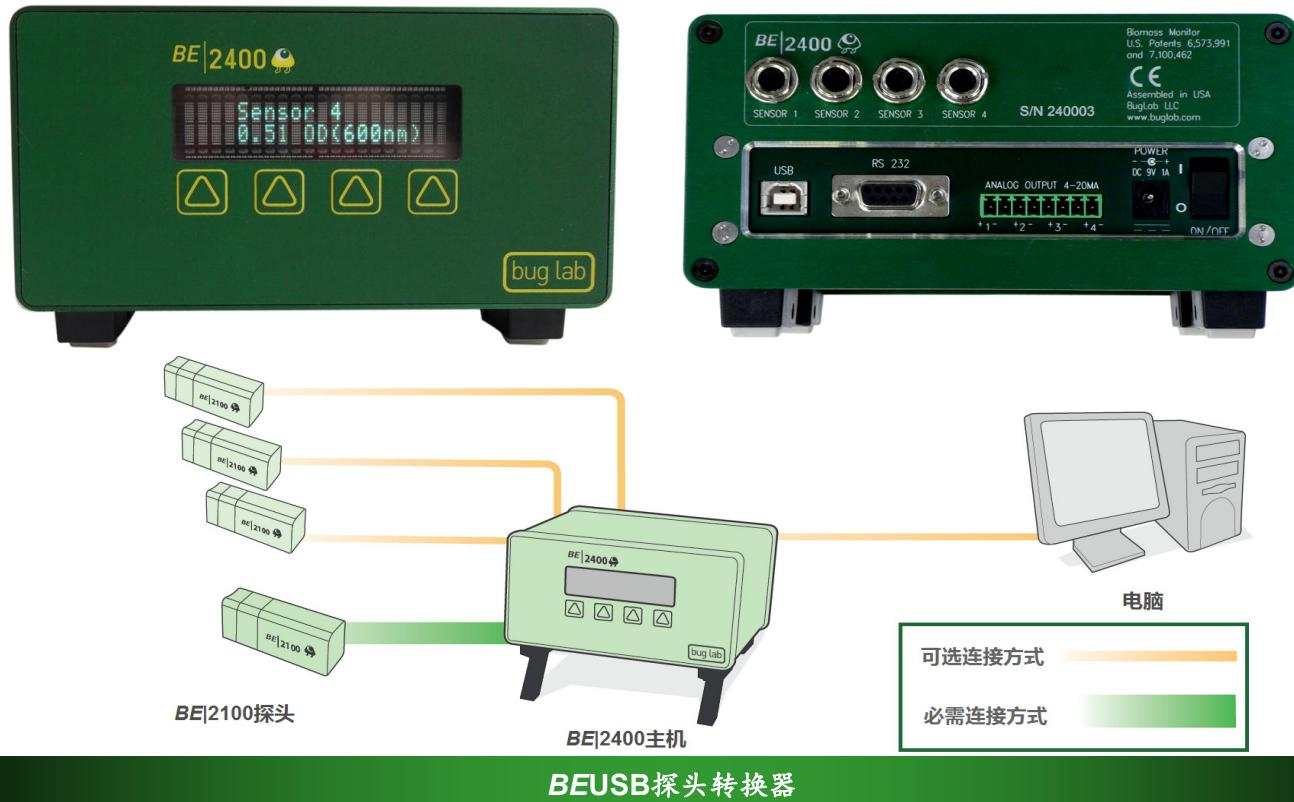
BEUSB是BugLab公司对其非浸入式光学OD值测量产品的进一步丰富。BEUSB通过USB连线向探头提供电源和传输数字信号，功能类似BE2100 主机，但体积更小，价格更低。适合不需要模拟数据输出、RS-232接口、液晶显示和操作面板的科研实验室或工业生产用户。
